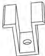
DOR 38363 - 749 gr./ml Profilo Omega per fissaggio centrale pannelli. Lavorazioni aggiuntive: taglio e foratura
