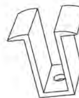
DOR 39709 - 882 gr./ml Profilo Omega per fissaggio centrale pannelli. Lavorazioni aggiuntive: taglio e foratura
